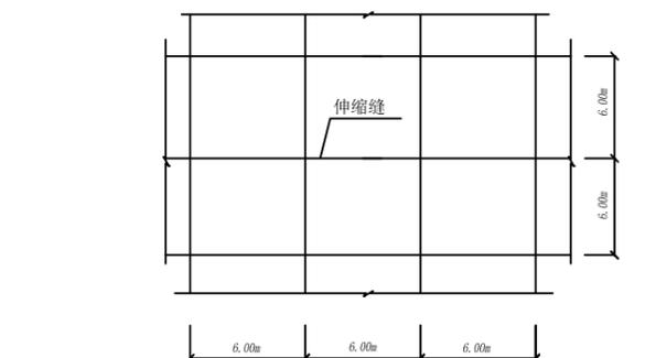
混凝土硬化面伸缩缝布置
