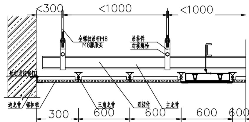
铝扣板吊顶安装节点图节点图 1:20
