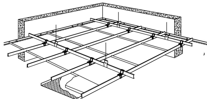
铝扣板吊顶安装节点图节点图 1:20
