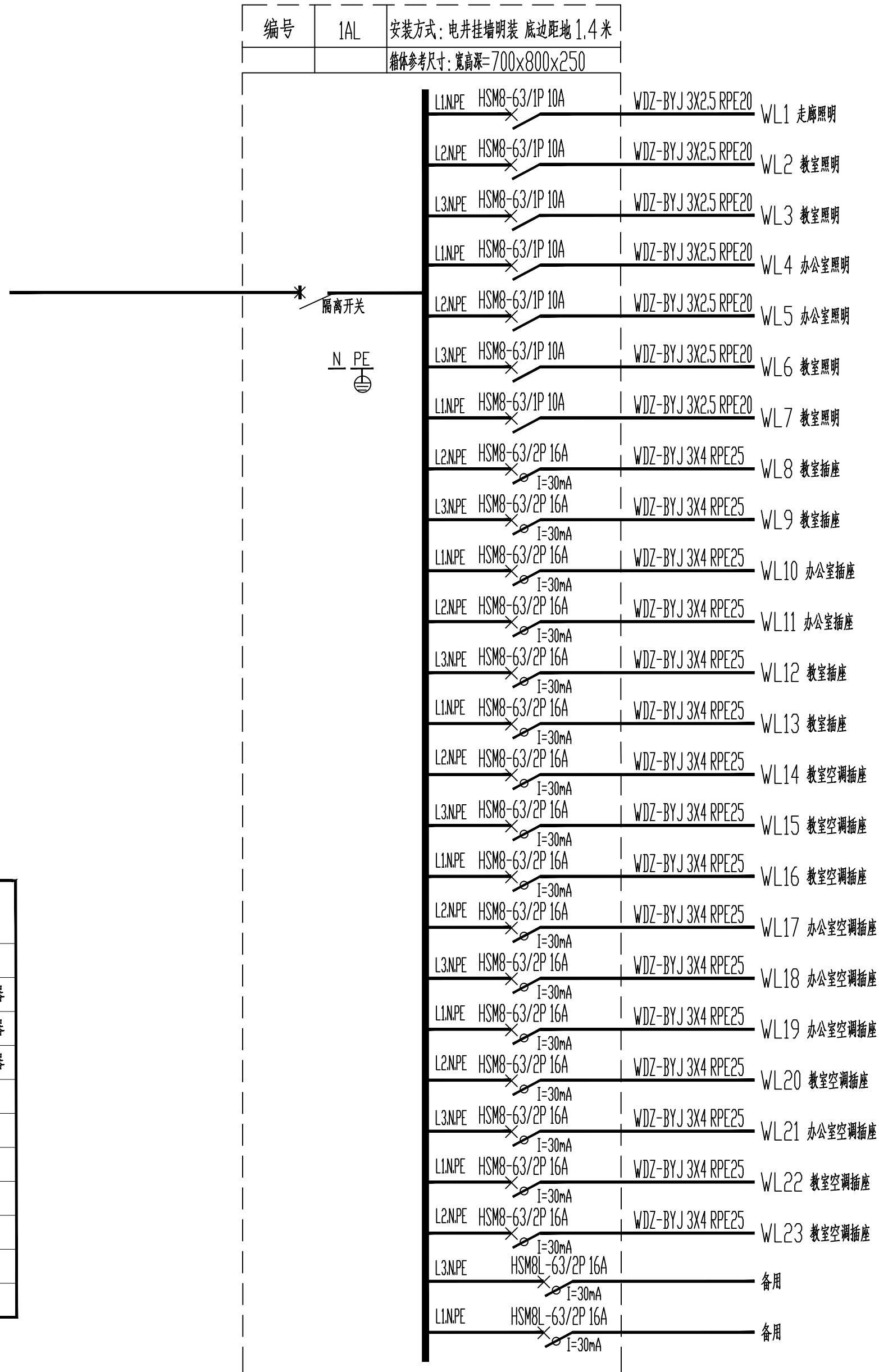
1AL 一层照明配电系统图
