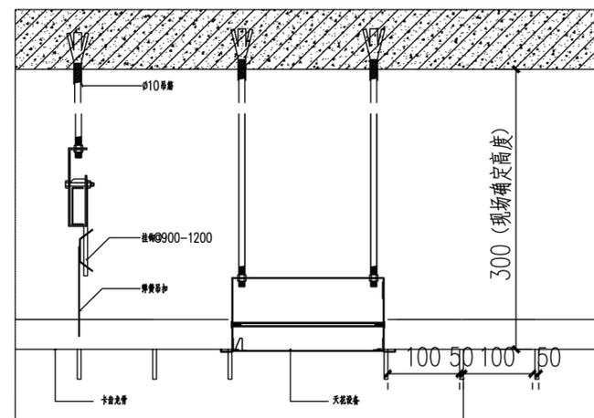
铝方通吊顶设备剖面图
