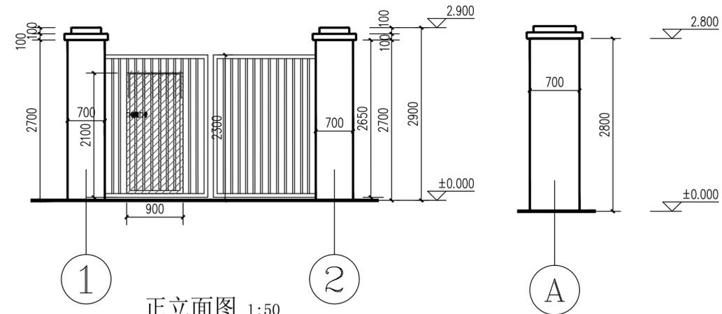
说明：通透死围墙维修，原有基础、墙柱保留。
