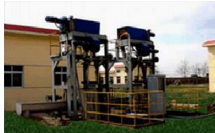
钢索式格栅的栅条是固定的，齿耙由链条带动上下运动，下行时齿耙张开，至格栅底部后闭合，上行时耙齿嵌入栅条，将栅条拦截的飘荡物去除。该型格栅基本可以克服回转式格栅难以去除较大尺寸的飘荡物的弱点。它的弱点是长期运行后，齿耙的两条钢索会产生紧张度不一致而导致齿耙不平，特别在泵房较深时，这个问题比较容易发生。
